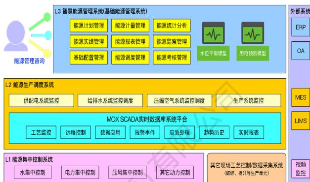
在矿山生产中，能源消耗主要集中于电力系统、动力系统(热力、压缩空气、氮气等)、排水系统等，能源管理系统对这些能源介质的生产、消耗进行数据采集、实时监控，并使用实时历史数据库将能源消耗的海量数据进行存储、分析，实现对能源设备、能源实绩、能源计划、能源绩效、能源成本、能源平衡、能源预测等全方位的监控和管理，达到矿山节能增效的目的。
