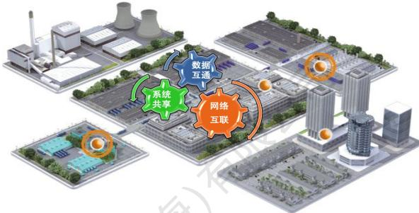
钢铁企业生产集中管控平台包含生产制造管控、物流运输调度、能源环保管理、设备运行监控和综合管控五大功能模块，实现对整个生产组织和工艺参数进行智能优化协调，各业务系统主要包括：生产调度系统、物流调度系统、能源管控系统、安防监控系统、设备管控系统、环保消防系统、无人计量系统和调度电话及应急预案系统。
